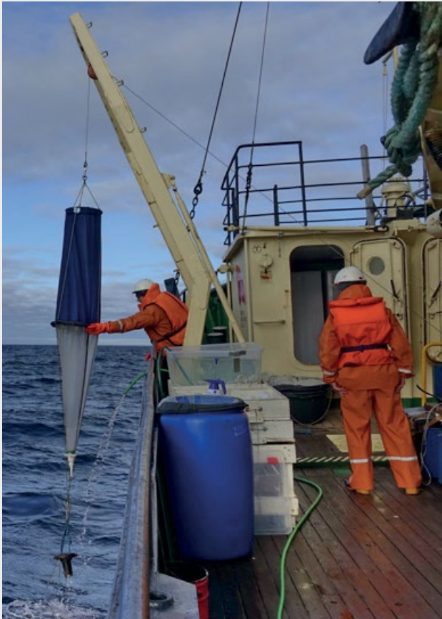
Рис. 18. Отбор проб зоопланктона сетью Джели (слева) и пробы морской воды батометром Нискина (справа)
