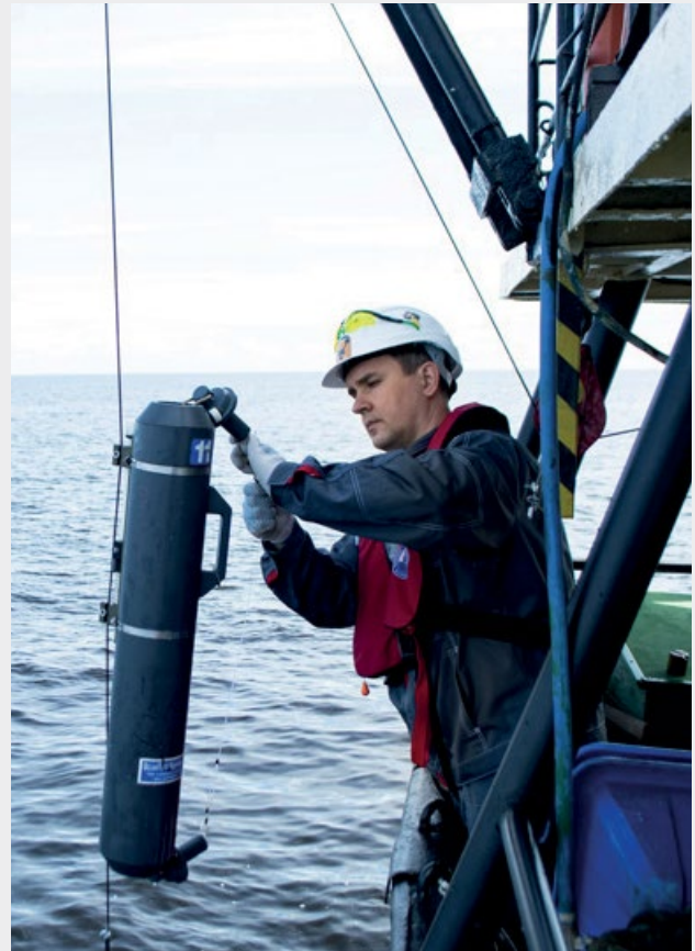
Рис. 18. Отбор проб зоопланктона сетью Джели (слева) и пробы морской воды батометром Нискина (справа)
